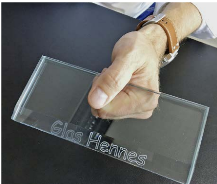
Komplexe Kantenbearbeitungen werden bei Glas Hennes aus Frechen alle auf einer Master 35 von Intermac umgesetzt, selbst Gravuren sind möglich (links im Bild)
